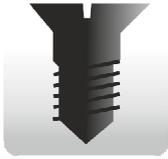
Para la fijación de los troncos laminados entre sí, se suministra un bulón especialmente diseñado por la industria italiana RothoBlass, posee una superficie recubierta para una mejor penetración, no es necesario pre – perforar la pieza a unir, la cabeza cónica permite que no sea necesario avellanado previo, posee aletas para la extracción de la viruta producida al penetrar en la madera.
